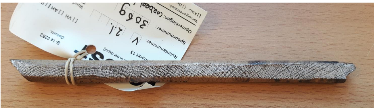
Het geprepareerde boormonster zonder spint. Het hout is aan één zijde vlak gesneden en het jaarringenpatroon is zichtbaar gemaakt met krijt.
