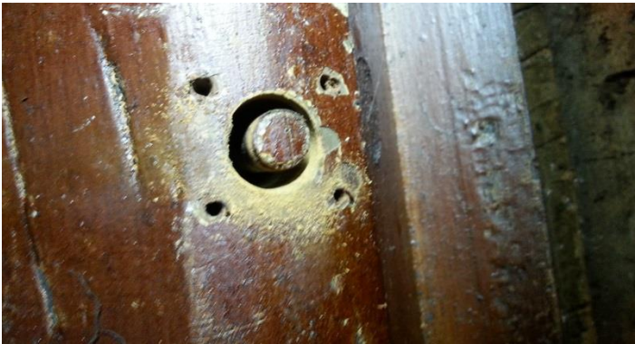
Boormonster wordt met een holle boor gezet.
